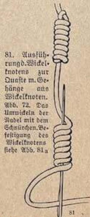
81. Ausführung d. Wickelnotens zur Quaste m. Gehänge aus Wickelnoten. Abb. 72. Das Umwideln der Nadel mit dem Schnürchen. Befestigung des Wickelnotens siehe Abb. 81a
