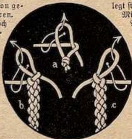
88a—c. Die Herstellung der Rundschnur Abb. 88. Abb. 88a. Anlage der Fäden zur Bildung der Schlinge. 88b. Erste Schlinge festgezogen, die zweite Schlinge in entgegengesetzter Richtung, siehe 88c
